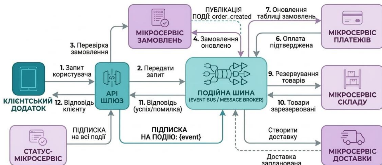
Рис. 2.8 – МСА з розподіленою подійно-орієнтованою комунікацією (хореографією): сценарій успішної обробки замовлення (взаємодія здійснюється асинхронно шляхом публікації подій та підписки на них через подійну шину)
