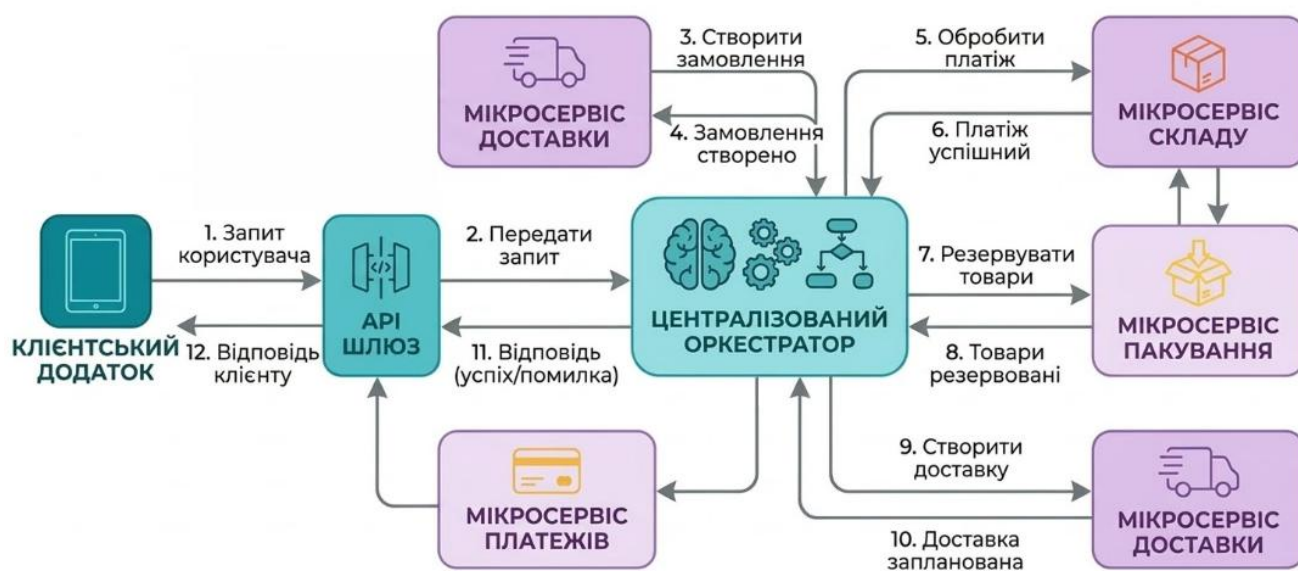
Рис. 2.7 – МСА з централізованою логікою взаємодії (оркестрацією): сценарій успішного виконання транзакції (етапи 1, 2 – отримання запиту; етапи 3-10 – послідовне делегування задач мікросервісам та отримання підтверджень; етапи 11, 12 – повернення успішного результату клієнту).
